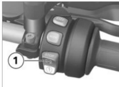
1 Экстренный выключатель зажигания
