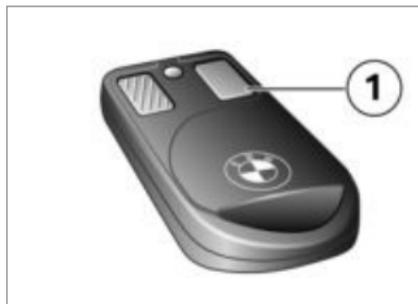
Сигнал тревоги звучит 26 секунд. Еще через 12 секунд система снова активируется. Прервать сработавший сигнал тревоги можно нажатием кнопки **1** на ключе дистанционного управления. Данная функция не изменяет режим системы охранной сигнализации. В течение этого времени звучит звуковой сигнал и мигают указатели поворота. Вид звукового сигнала можно запрограммировать.
