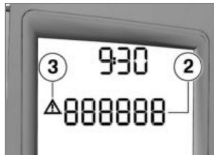
Дополнительно рядом с **2** может отображаться символ знака аварийной остановки **3**. Эти предостережения отображаются поочередно с показаниями счетчика пробега (►► 51).
