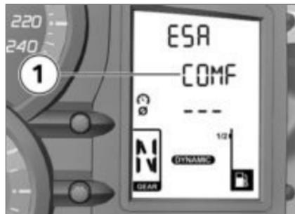
Установленная степень жесткости амортизаторов отображается на многофункциональном
