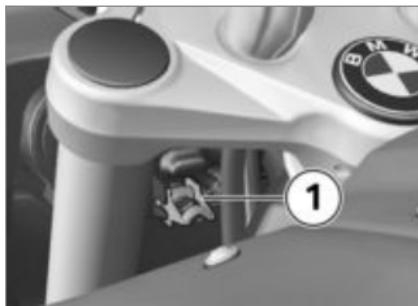
**1** Система регулировки угла наклона фары
