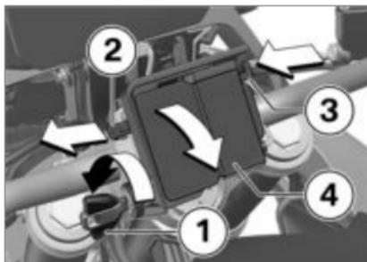
• Поверните ключ зажигания **1** против часовой стрелки.
