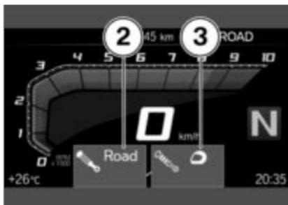
Сразу после нажатия кнопки **1** отображаются настройки амортизации **2** и предварительного напряжения пружины **3**.
