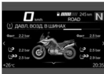
Значения слева относятся к переднему колесу, значения справа — к заднему. Дополнительно к фактическим значениям показываются заданные значения в зависимости от загрузки мотоцикла. Сразу после включения зажигания отображаются только черточки. Фактические значения давления в шинах начинают передаваться только после первого превышения следующей минимальной скорости:
