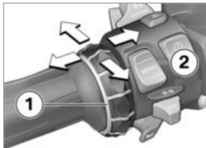
Для управления всем содержимым дисплея используется мультиконтроллер **1** и двухпозиционная клавиша MENU **2**. В зависимости от контекста доступны следующие функции.
