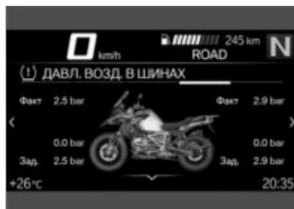
Значения слева относятся к переднему колесу, значения справа — к заднему. Разность давлений отображается в виде заданного и фактического давления в шинах.
