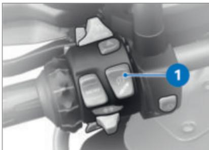
• Нажмите и удерживайте кнопку **1**, пока не изменится характер индикации контрольной лампы DTC.
