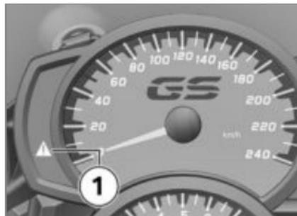
Предупреждения, для которых не предусмотрены отдельные сигнальные лампы, отображаются с помощью общей сигнальной лампы **1** в сочетании с предупреждением или предупреждающим символом на многофункциональном дисплее. В зависимости от степени важности предупреждения общая
