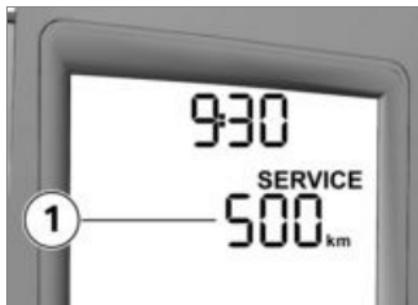
При высоких показателях годового пробега в силу определенных обстоятельств может потребоваться внеплановое ТО. Если до планового ТО остается меньше 1000 км, оставшийся до ТО пробег **1** будет отображаться с шагом 100 км. Индикация выводится на короткое время на дисплей по окончании проверки Pre-Ride-Check.
