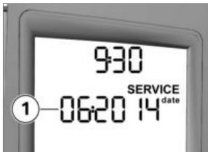
Если время, оставшееся до следующего ТО, не превышает месяца, дата ТО **1** на короткое время отображается на дисплее по окончании проверки Pre-Ride-Check. Месяц и год отображаются в виде двузначного и четырехзначного числа, разделенных двоеточием. В данном примере индикация должна читаться как «июнь 2014».
