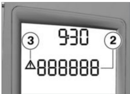
Дополнительно рядом с **2** может отображаться символ знака аварийной остановки **3**. Эти предостережения отображаются поочередно с показаниями счетчиков пробега (▣► 47).
