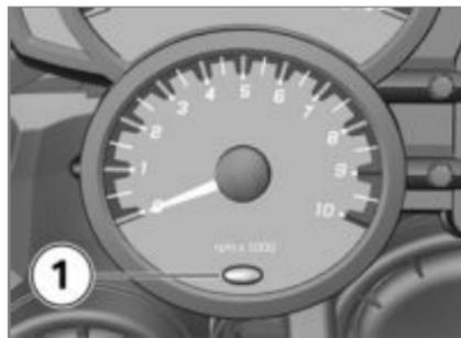
Сигнализатор превышения допустимой частоты вращения указывает водителю на достижение красного диапазона частоты вращения. При появлении данного сигнала сигнализатор превышения допустимой частоты вращения **1** мигает красным цветом.
