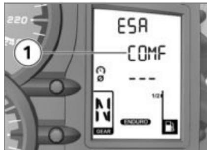
Установленная степень жесткости амортизаторов отображается на многофункциональном
