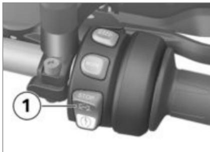
1 Экстренный выключатель зажигания
