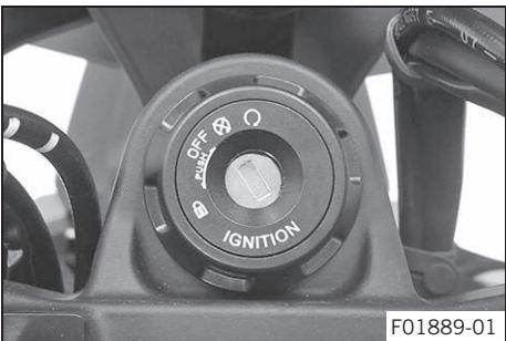
Замок зажигания и замок блокировки рулевой колонки находится в передней части верхней траверсы.
