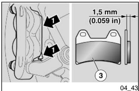
Para realizar el control rápido del desgaste de las pastillas:
