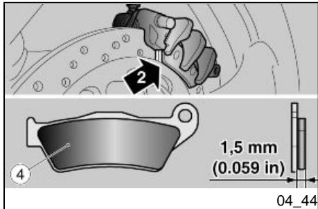
SARÍA EL CONTACTO DEL SOPORTE METÁLICO DE LA PASTILLA CON EL DISCO, CON EL CONSIGUIENTE RUIDO METÁLICO Y ESCAPE DE CHISPAS DE LA PINZA; LA EFICACIA DE FRENADO, LA SEGURIDAD Y EL BUEN ESTADO DEL DISCO QUEDARÍAN DE ESTE MODO COMPROMETIDOS.
