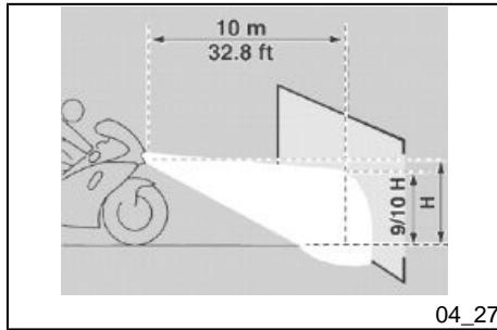
Para realizar un control rápido de la orientación correcta del haz luminoso delantero:
