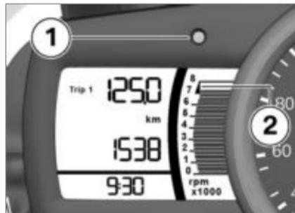
Предупреждение тахометра **1** извещает водителя о достижении красного диапазона частоты вращения **2**. Сигнал сохраняется до тех пор, пока не будет выполнено переключение на повышенную передачу или уменьшение частоты вращения.
